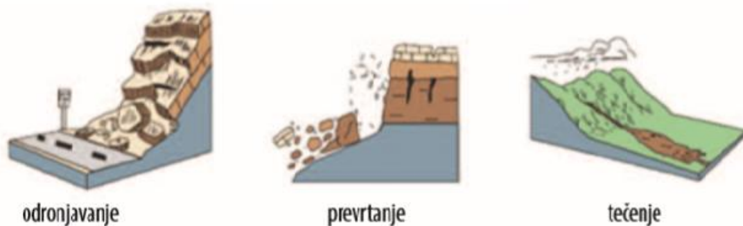
Slika 25. Prikaz osnovnih tipova klizanja prema mehanizmu kretanja
